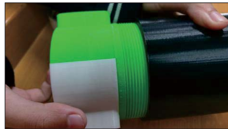
圖 6、透鏡組連接投影主體
