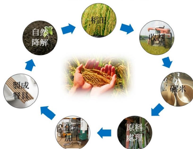
圖 11 稻殼筷的生產加工流程（註 1）
